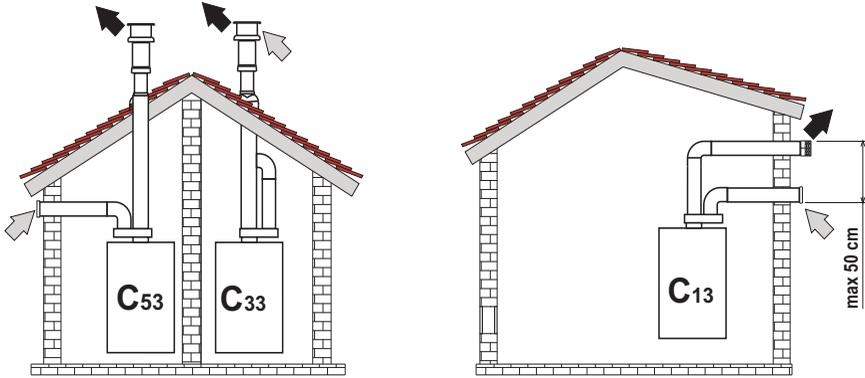
fig. 35- Exemple de racordare cu tuburi separate
